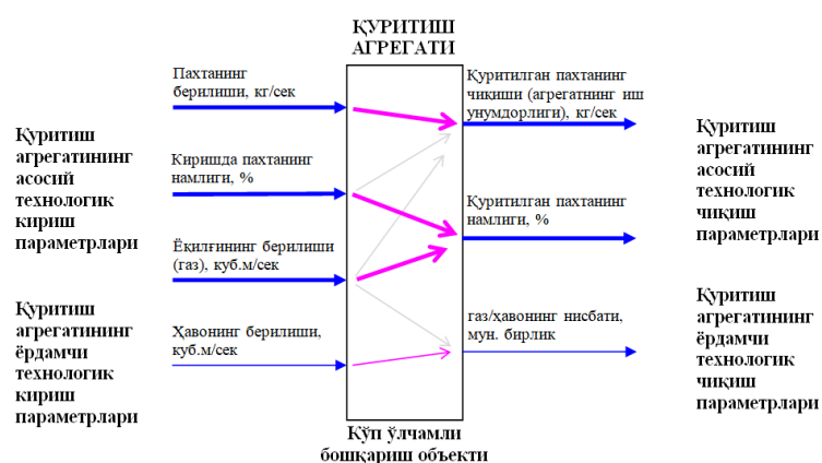
1-rasm. Quritish agregatini soddalashtirilgan funktsional-texnologik sxemasi
