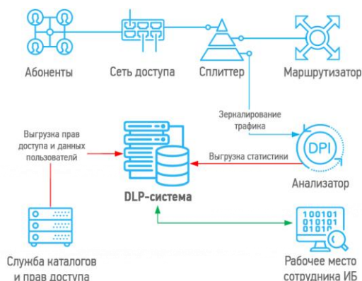
Рисунок 2. Принцип работы DLP-программ
