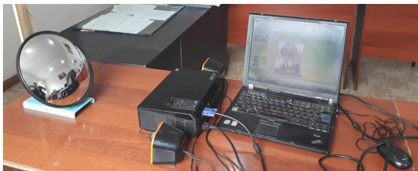
Элементы проекционной аппаратуры для Планетария: сферическое зеркало, проектор, звуковые колонки и компьютер
