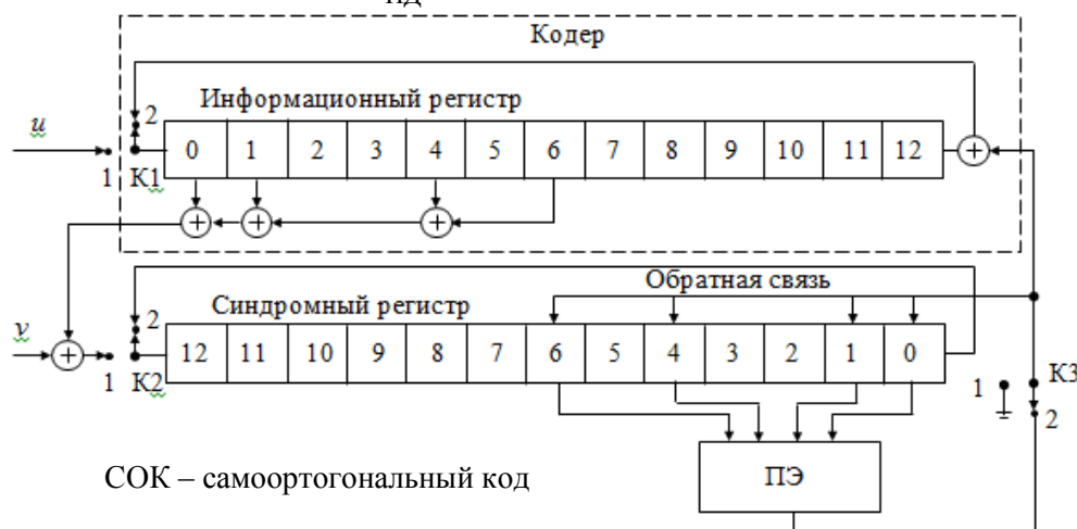
Рис.1. ПД блочного СОК с n=26 , r=1/2 , d=5 и g(x) = 1 + x + x^4 + x^6
