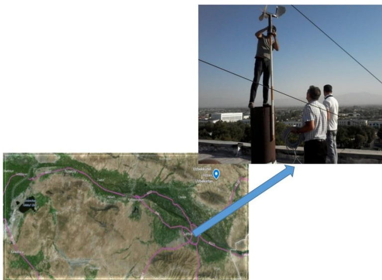
Рис. 3. Установка анеморумбометра на крыше высотного здания, г. Самарканд
