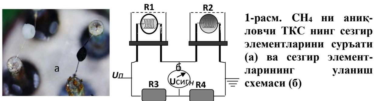
1-расм.  $\text{CH}_4$  ни аниқловчи ТКС нинг сезгир элементларини суръати (а) ва сезгир элементларининг уланиш схемаси (б)
