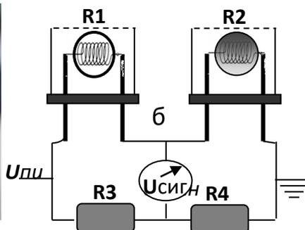
**Рис.1. Фотография (а) и схема включения (б) чувствительных элементов термокаталитического сенсора метана (слева—сравнительный ЧЭ, справа—измерительный ЧЭ).**
