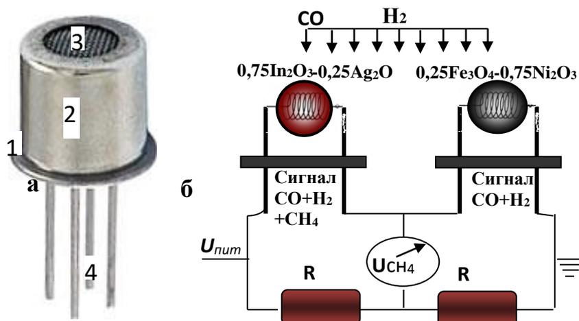
2-расм. Селектив термокаталитик сенсорнинг расми (а) ва улашиш схемаси (б) (1-корпус, 2-химоя қобиғи, 3-ғовак титан тўри, 4-металл оёқлар)
