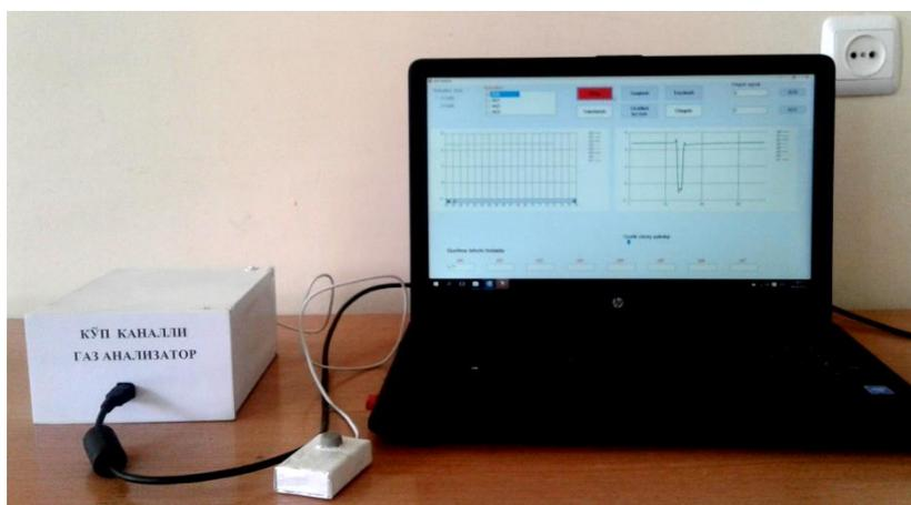
**Рис. 5.** Внешний вид двухканального газоанализатора метана
