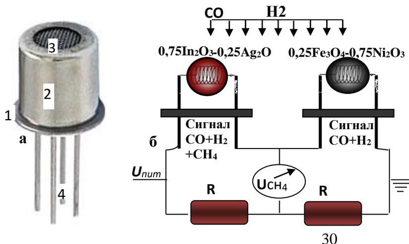
**Рис.2. Фотография (а) и схема (б) селективного термокаталитического сенсора метана (1-корпус, 2-защитный колпачок, 3-пористая титановая сетка, 4-металлические стойки**
