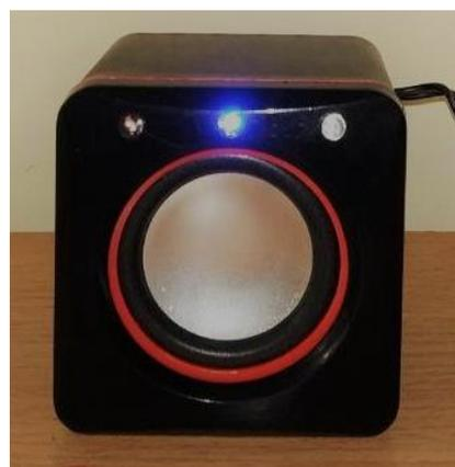
**Рис.-3. Внешний вид термокаталитического сигнализатора.** Стационарный бытовой сигнализатор предназначен для непрерывного автоматического контроля содержания  $\text{CH}_4$  и природного газа в воздухе закрытых промышленных и коммунально-бытовых помещений и выдачи сигнализации о превышении установленных значений объемной доли горючих газов. Зависимости сигнала сигнализатора от концентрации при заданных значениях последнего приведены в таблице 7.
