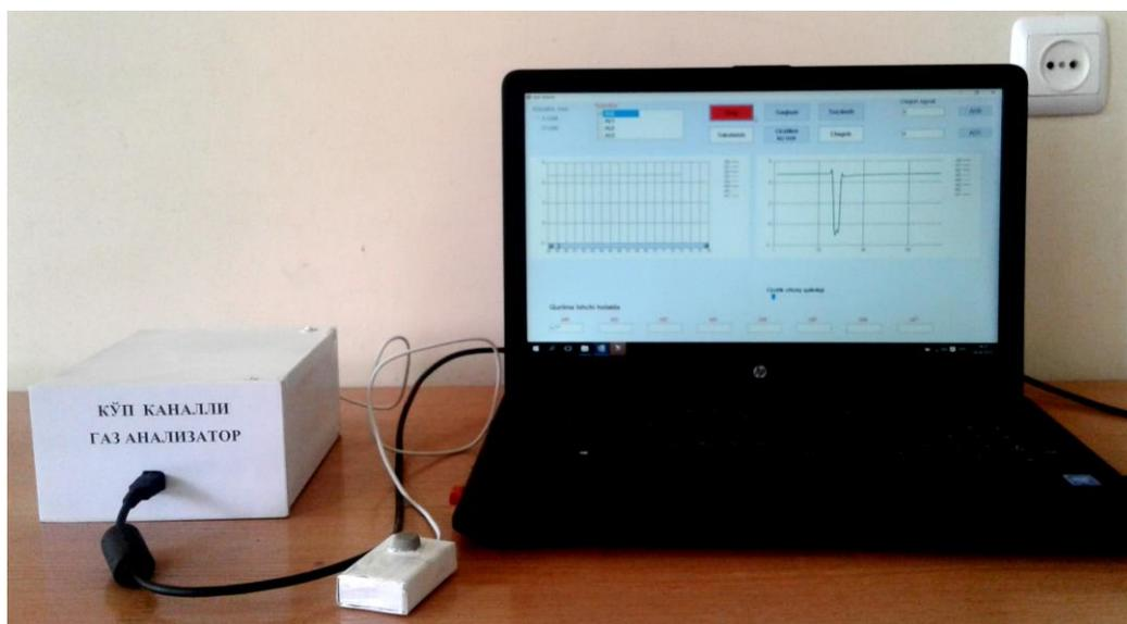
**5-расм. Метанни аниқловчи икки каналли газ анализатор**
