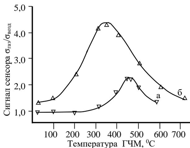
**Рис.4.** Температурные зависимости сигнала полупроводникового сенсора от состава газочувствительного материала: 1- $\text{SiO}_2/\text{ZnO}+1\% \text{CoO}$ ; 2- $\text{SiO}_2/\text{ZnO}+10\% \text{CoO}$ . (Содержание  $\text{CH}_4$  в смеси  $250\text{мг}/\text{м}^3$ )
