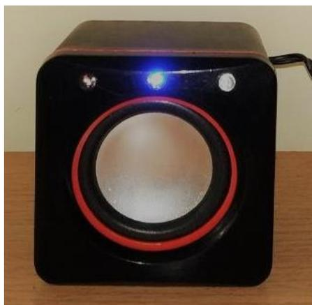
Ушбу селектив ТКС асосида ишлаб чиқилган сигнализатор ёпиқ экологик системаларда табиий газни сизиб чиқиши ва тўпланишини назорат қилиш жараёнининг ишончли мониторингини таъминлайди. Сигнализатор ёпиқ хоналар атмосфера ҳавоси таркибидан  $\text{CH}_4$  ни узлуксиз назорат қилиш ва концентрация белгиланган чегара қийматидан ортганида сигнал беришга мўлжалланган.
