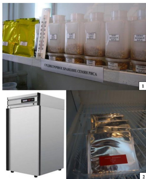
Рис. 1. Коллекция семян лаборатории криосохранения гермоплазмы ИББР: 1 – температурный режим хранения +4^{\circ}\text{C} ; 2 – температурный режим хранения -20^{\circ}\text{C}
