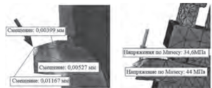
Рис. 4. Деформации и напряжение по Мизесу в указанных точках
