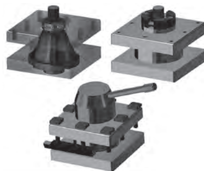
Рис. 3. Последовательность выполнения сборки: резцовая головка устанавливается на коническую оправку, вставляются упорный подшипник, который обеспечивает жесткую посадку, шайба, полукольца с закреплением болтами; закрепляется затяжная головка со вставленной рукояткой; устанавливаются и затягиваются винты, закрепляющие резец с необходимым вылетом
