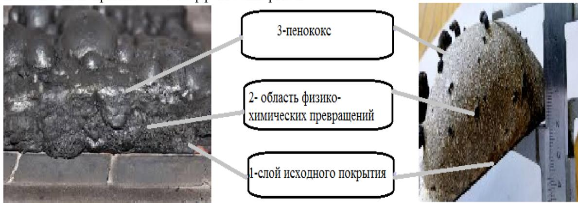
**Рис. 1.** Образцы испытания вспучивающегося олигомерного антипирена с пентафтальевым лаком.
